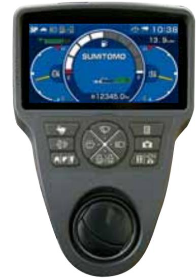
視認性の高い横型タイプのフルカラーモニターを搭載。スイッチパネルと一体化したデザインで、各種機能を集約しています。また、低燃費状態を表示するECOゲージや作動状態の表示、警告等のメッセージ表示も実現。正確な情報伝達により、作業効率や安全性を高めています。
