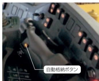
固定マウント式ハンドグリップを採用。足場の悪い現場でも確実に保持できるため、正確なリッピング作業が行え、誤作動も防ぎます。リッパ自動格納機能により、サイクルタイムが短縮し、生産性が向上します。
