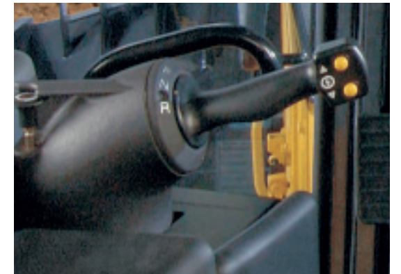
▲1本のハンドルで前後進切替と変速操作、旋回角度とスピード調整が行えます。
