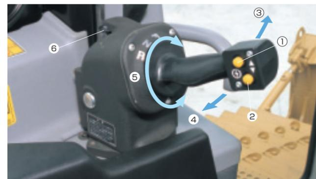
▲1本のハンドル(ツイストグリップ)で前後進切替と変速操作、旋回角度とスピード調整が行えます。
