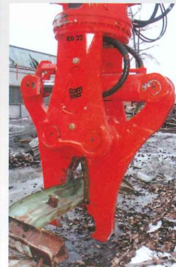
交換可能な切削刃はRD18の幅広い用途を可能にします。
