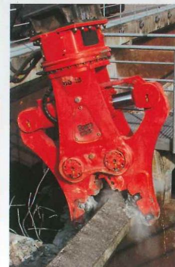
交換可能な切削刃はRD18の幅広い用途を可能にします。
