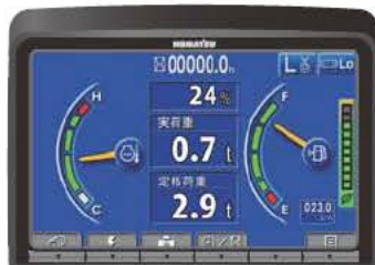
定格荷重・実荷重・負荷率表示
