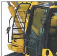
キャブフロントフルガード レベル1 (ISO 10262) (開閉式アッパーガード付)
