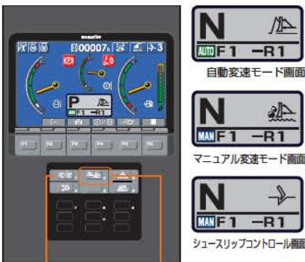
運転モード切り換えスイッチ 変速モード切り換えスイッチ
