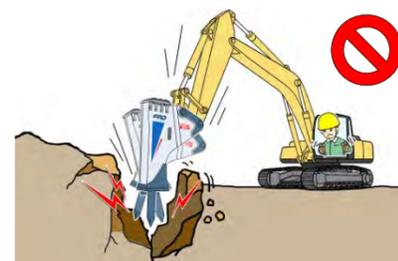
ロッドをこじりながらの破砕作業は、ロッドが折れたり油圧ショベルを壊す原因になります。
