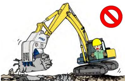
作業装置が覆帯に対し直角方向になる状態で作業を行うと、油圧ショベルの浮き上がりや横転などの恐れがあります。
