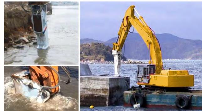
水中仕様油圧ブレーカは、ロッド部が水没する水中での破碎作業に使用されます。エアコンプレッサを搭載することで油圧ブレーカ本体内部への水の浸入を防ぎ、水中での作業を可能にしています。
