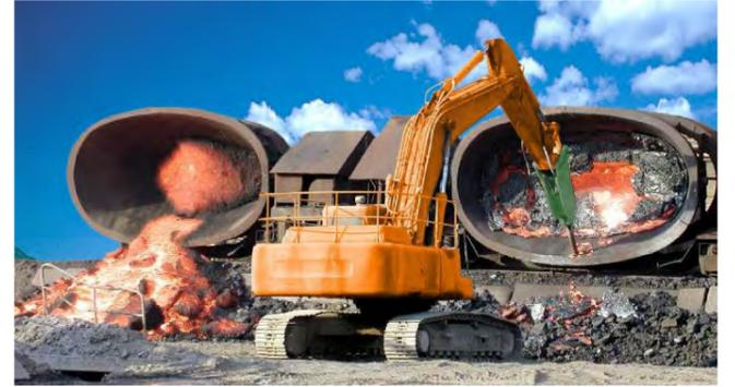
耐熱仕様油圧ブレーカは、ブレーカ本体のシール類を耐熱仕様にした他、グラスウール巻きの耐熱ホースの装備、ロッド支持部を長尺化したロングフロントカバーの採用、ツバ付ロッドの装着など、耐熱仕様に特化し工夫を凝らされた油圧ブレーカです。
