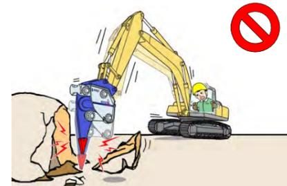
空打ちは、エキセントリックリッパ本体に過大な打撃振動を発生させ、油圧ショベルを壊す原因にもなります。空打ち状態になりやすい小割作業はしないでください。
