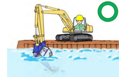
エキセントリックリッパの駆動部は、完全密閉構造になっています。水や泥の中でも、破碎作業ができます。
