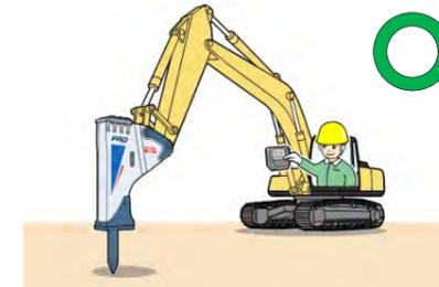
油圧ブレーカでの作業に最適な、油圧ブレーカモードに設定してください。
