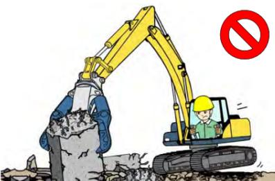
油圧ショベルを転倒させる恐れがあります。油圧ショベルの安全作業半径の制限と許容質量とを守って作業をしてください。
