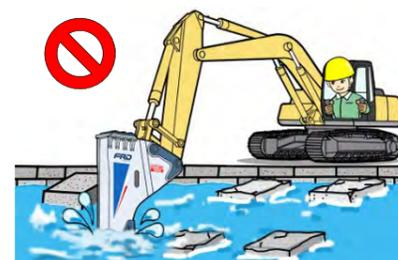
ブレーカ本体に水や泥が入り、ブレーカだけでなく油圧ショベルの重大な故障にもつながります。
