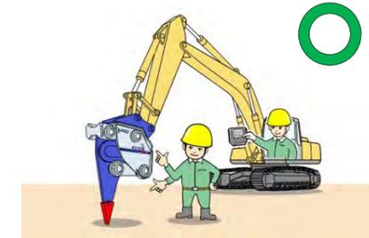
ツースの摩耗状態や油圧ホース、油圧モータ、アーム駆動部などからオイル漏れはないか、目視で点検します。
