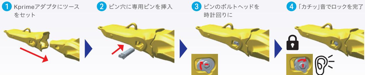
\*取り外しはラチェットを反時計回りに90度回転、ピンが押し出され、「カチッ」音で完了。
